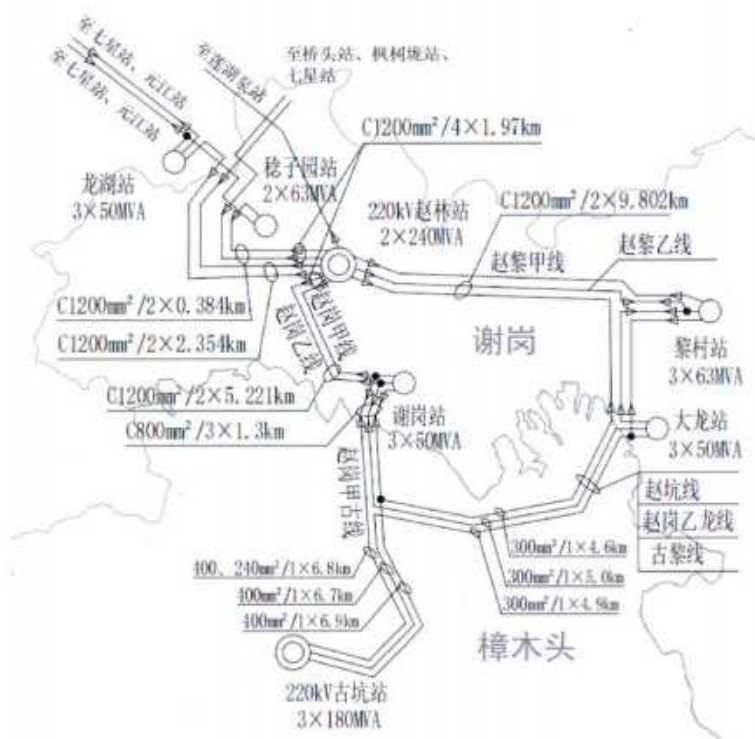
图3.7.4-1 储能电站接入前近区110kV电网图
