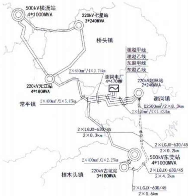
图3.7.4-2 储能电站接入前近区220kV电网图
