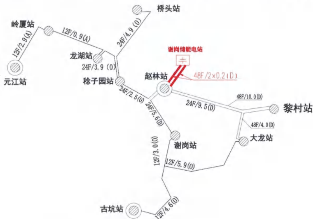
图5.7.2 与本工程相关光缆的建设路由图
