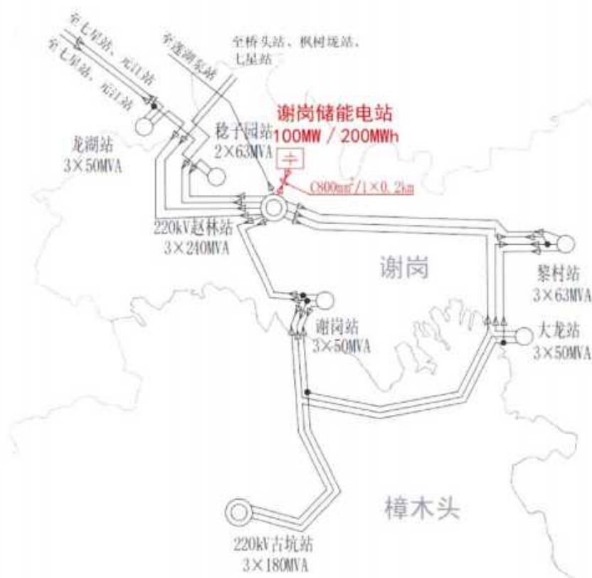
图3.7.4-3 接入系统方案一(110kV接入赵林站)
