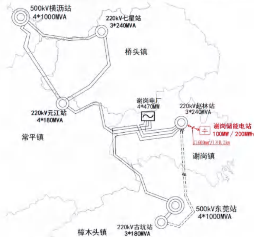
图3.7.4-4 接入系统方案二（220kV接入赵林站）
